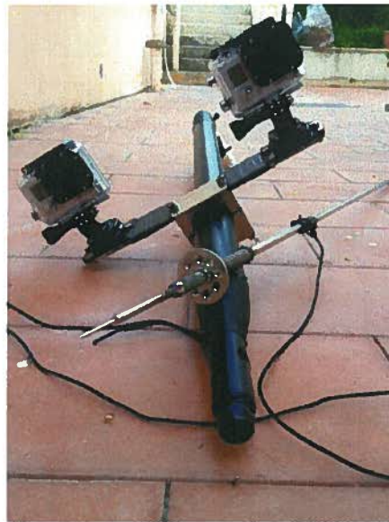
Fucile oleopneumatico armato con sistema SMAT e corredato da supporto e videocamere per riprese vista operatore di marcatura
