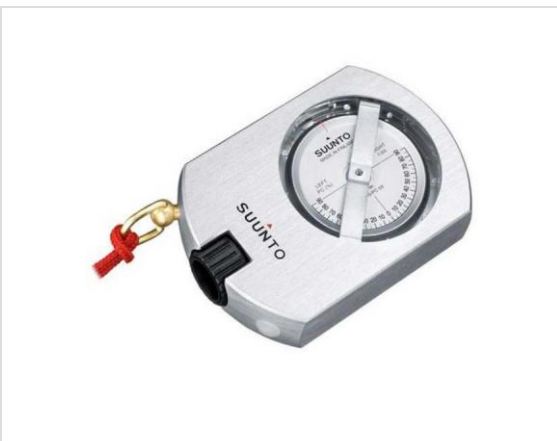
Imagen 11. Clinómetro SUUNTO modelo PM5 utilizado durante los vuelos para medir los ángulos.
