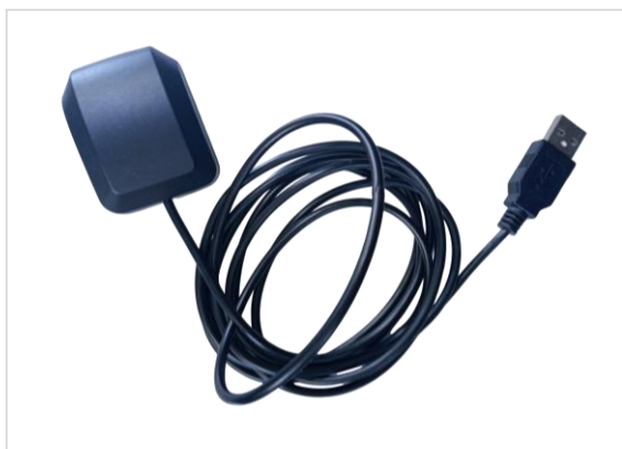
Imagen 5. Antena GPS conectada al ordenador para la toma automática de datos de posicionamiento.
