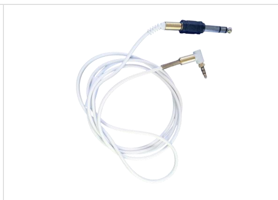
Imagen 6. Cable minijack-minijack con adaptador de clavija para conectar el sistema de comunicaciones de la avioneta con el sistema de audio del ordenador.
