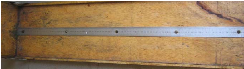
Figure 4.3.2. Exemple de planchette graduée. Photo de Sarralde et al. (2005), reproduite avec l'autorisation de l'auteur.
