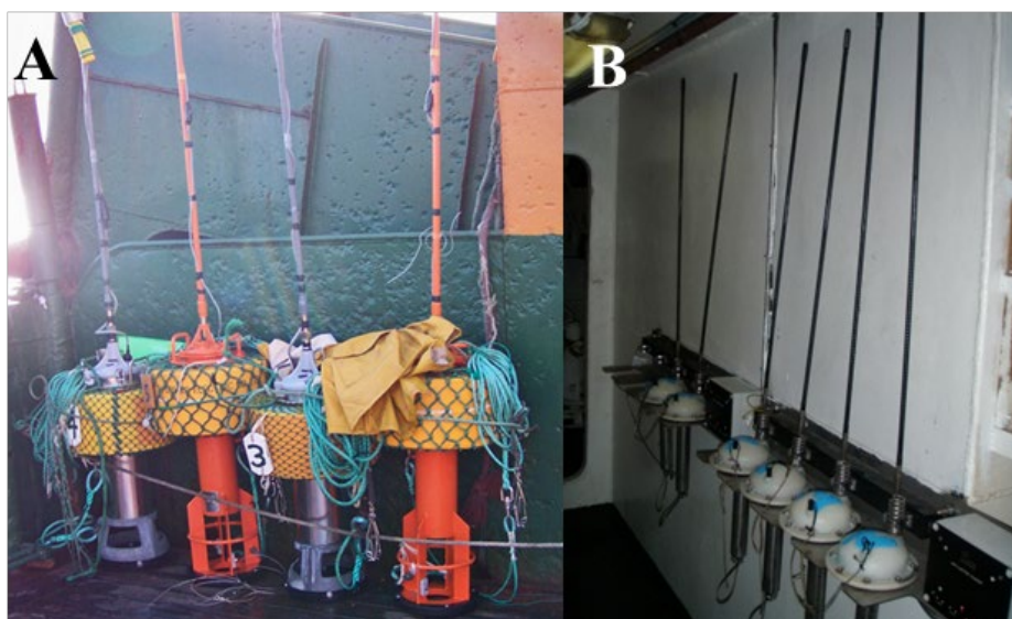
Figure 18. A : Bouées radio à batterie ; B : Antennes de bouées GPS sur leur socle de recharge de batterie.
