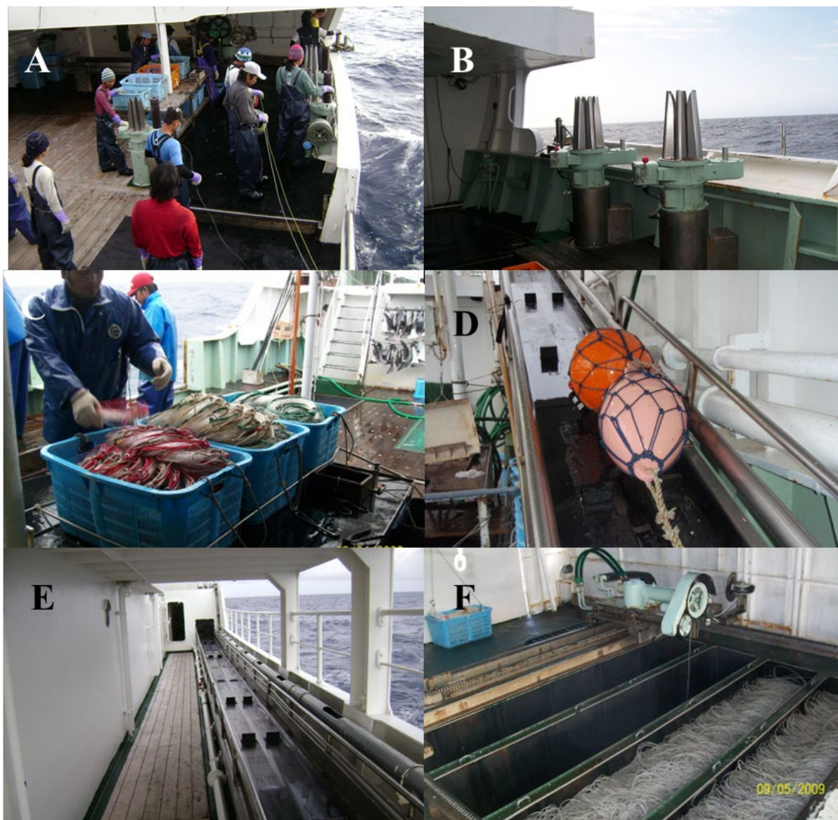
Figure 32. Virage d'une palangre profonde de type asiatique. A : membres de l'équipage sur le pont en train de procéder au virage ; B : vireurs automatiques d'avançons ; C : glène d'avançons et d'orins dans des bacs ; D - E : tapis roulant de bacs et de bouées allant du pont à la zone de filage à l'arrière ; F : entreposage de la ligne-mère sous le pont.
