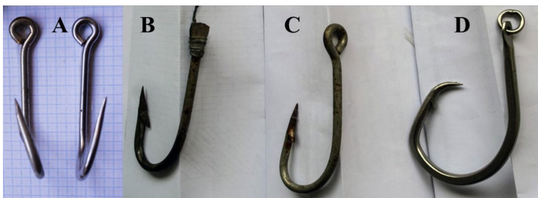
Figure 22. A : Hameçons avec courbure désaxée ; B : Hameçons à palette ; C : Avec une hampe avec œil ; D : Avec anneau.
