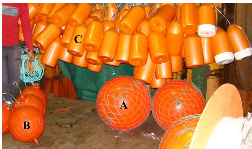
Figure 3. Différents types de bouées utilisées sur les palangres. A : en PVC gonflable, B : en plastique rigide, C : en polyuréthane.
