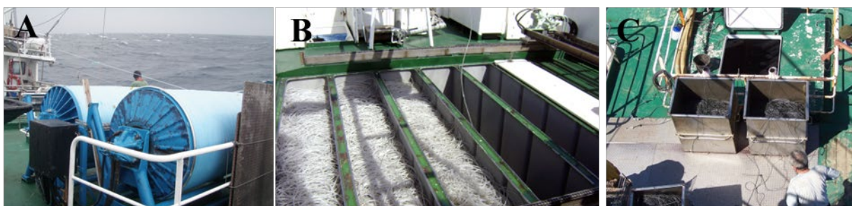
Figure 8. Différentes façons d'entreposer la ligne-mère à bord. A: sur des bobines; B: dans des baquets sous le pont; C: dans des caissons.
