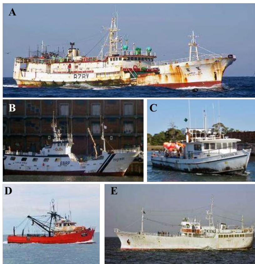
Figure 6. Différents types de palangriers. A et E : navires congélateurs asiatiques (-60 °C) ; B : navire espagnol de produits congelés et frais (-4/-30 °C) ; C : Navire côtier utilisé pour la pêche tropicale (produit frais) ; D : navire pêchant au filet soulevé modifié pour la pêche à l'espadon (produit frais).
