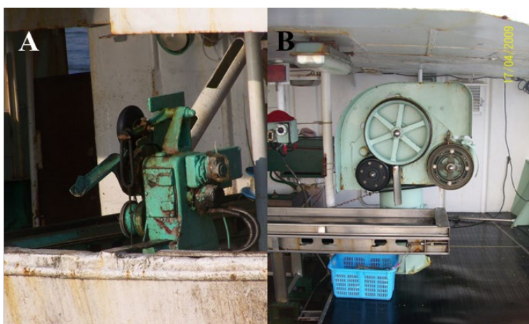
Figure 34. A : éjecteur de ligne-mère situé à l'arrière du navire ; B : vireur de ligne-mère situé dans le parc à poissons.
