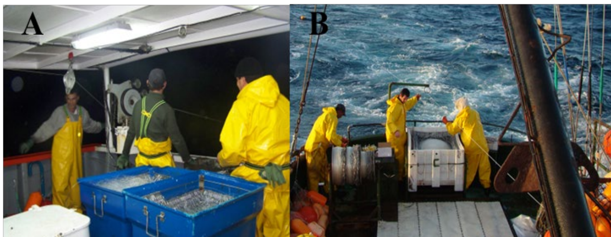
Figure 23. A : Filage avec un éjecteur de ligne-mère ; B : Filage sans éjecteur de ligne-mère.
