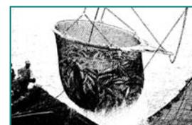
**Figure 3.** Salabarde de 10 t utilisée dans la pêche à la senne visant les thonidés tropicaux (Túnidos IEO 2007).
