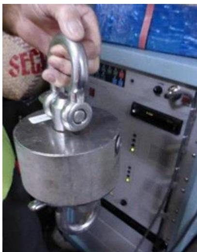
**Figure 7.** Balance à crochet Bluetooth
