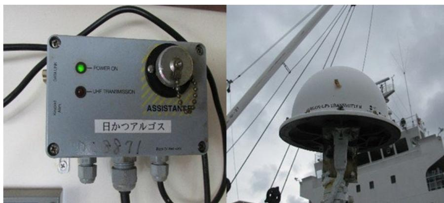
**Figure 16.** Unité Argos MARGE avec voyant d'alimentation allumé et antenne correspondante
