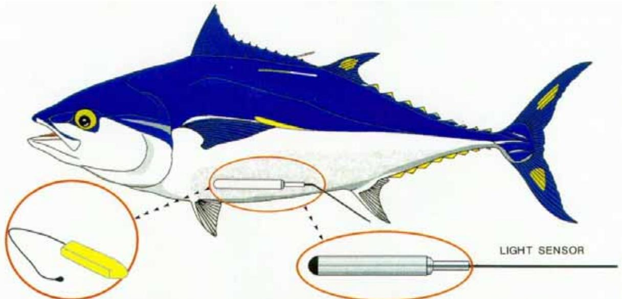
**O que são marcas arquivo?** Marcas arquivo são aparelhos electrónicos de armazenamento de dados colocados no interior do peixe que registam a informação diária sobre a sua localização, através de um sensor de luz. Fornecem também informações sobre a profundidade de natação, temperatura da água, e temperatura do corpo do peixe. Esta informação é recolhida diariamente e armazenada na marca durante vários anos.
