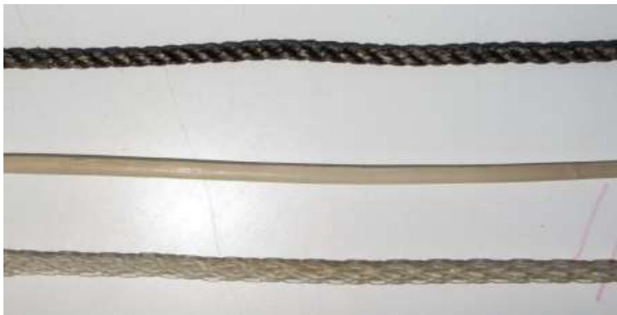
Figura 2. Línea madre de multifilamento de nylon, monofilamento de poliamida y nylon trenzado (de arriba abajo).
