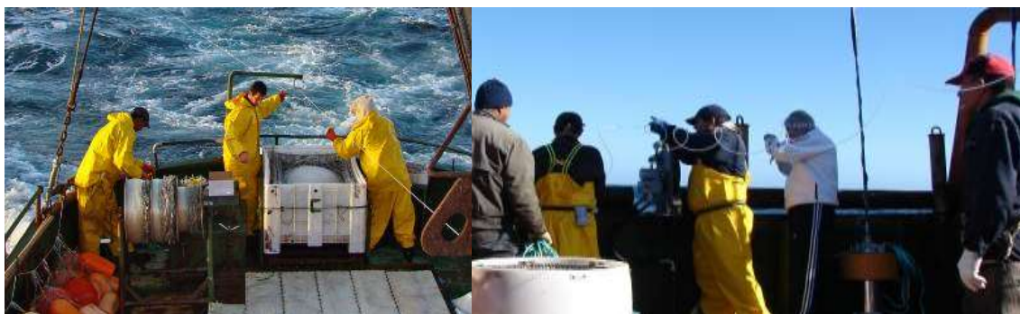
Figura 33. a) Calado con 3 marineros sin lanzador de línea madre; b) calado con 5 marineros y lanzador de línea madre.
