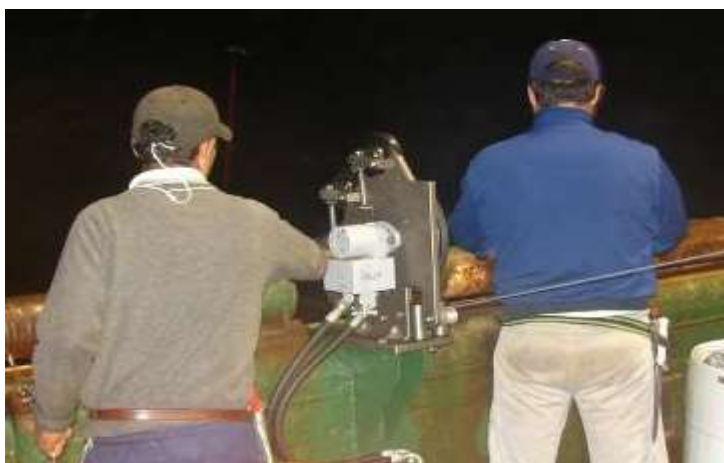
Figura 32. Lanzador de línea madre.
