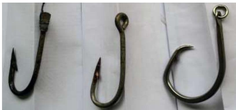
Figura 31. Anzuelos con espátula, caña con ojo y con argolla.
