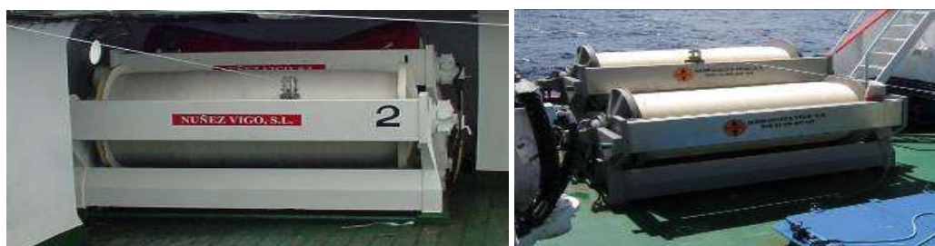
Figura 8. Carretes “spool” para estibar la línea madre de monofilamento.
