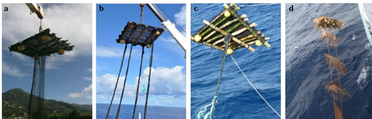
**Figure 7.** Evolution des DCP mis à l'eau par la flottille française : a) ancien DCP (avant 2011) ; b) DCP non-maillant construit à bord des navires à partir de 2010 ; c) DCP non-maillant construit dans les ateliers à terre depuis 2013 ; d) nouveau DCP non-maillant et biodégradable testé en 2014 (©Orthongel).
